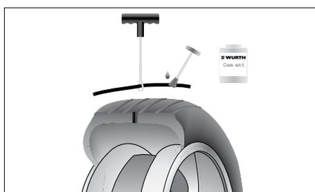
Infilare il WRS nel posatore come illustrato e soluzionare bene il WRS con mastice vulcanizzante.
